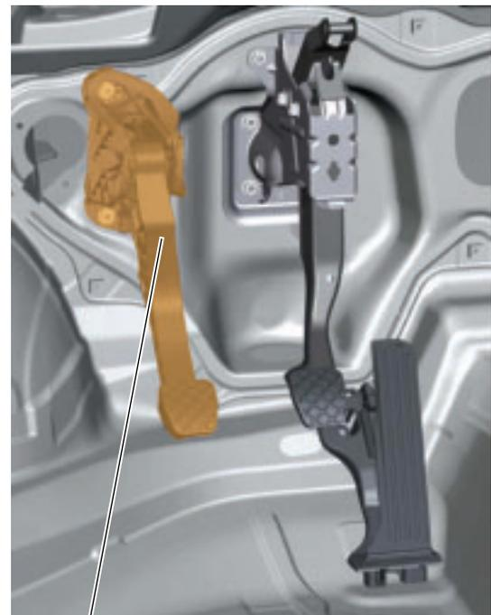
pedale della frizione con sensore della posizione della frizione
